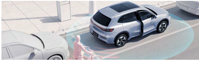
DOW Door Open Warning
